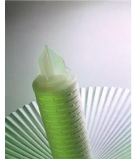
La cartuccia POLIXSTER ADM FREE è ottenuta pieghettando fino a 4 strati di filter media di poliestere a porosità a scalare che consentono di ottenere un grado di filtrazione molto preciso ed una elevata superficie filtrante. L'assemblaggio per sola termosaldatura assicura una struttura compatta e resistente anche a severe condizioni di esercizio.
