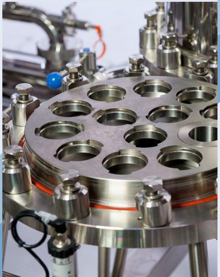
Zusätzliche Phase für die mikrobiologische Stabilisierung. Konstruktionsdetails der Platte für die Montage der letzten Filterelemente. Systemdesign für sicheren Verschluss des Filters.
